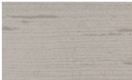
图 14 沿轧制方向出现的 HIC 裂纹
