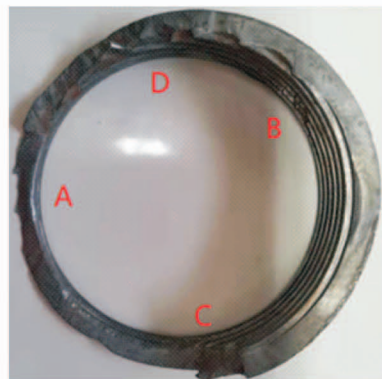
图6 清洗后的断口样品
