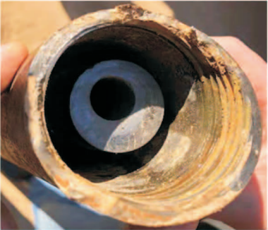
图 2 水力振荡器定子失效样品形貌
