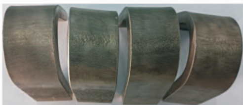
图4 Inconel601 镍基高温合金弯曲试样
