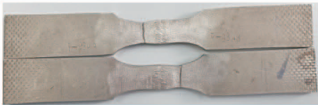
图 3 Inconel601 镍基高温合金拉伸试样
