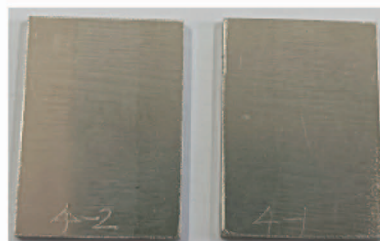
图5 Inconel601 镍基高温合金腐蚀后宏观试样
