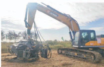
图 4 坡口机动力装置
