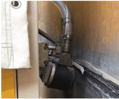
图 4 焊剂回收装置
