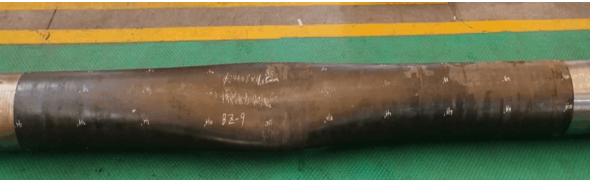
图 4 管体挤毁试样形貌
