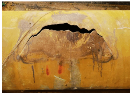
图 2 去除防腐层后泄漏部位钢管外壁形貌
