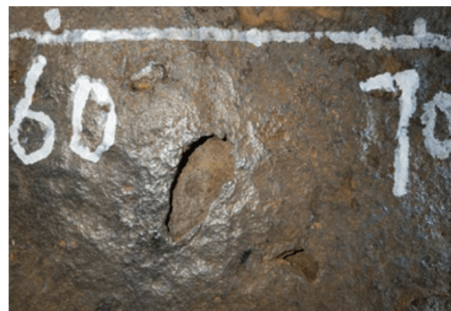
(b) 腐蚀坑深度 7.4 mm
