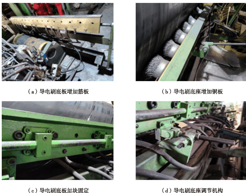
图 3 导电刷机构改进图
