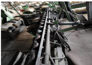
(a) 导电刷整体结构图
