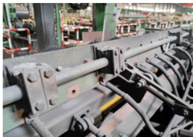
(b) 导电刷部分结构图
