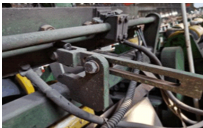
图 2 导电刷角度调节机构
