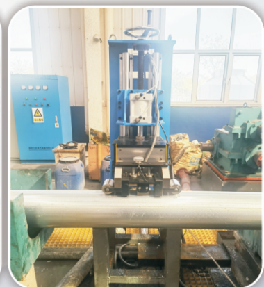
大口径管焊缝探伤
