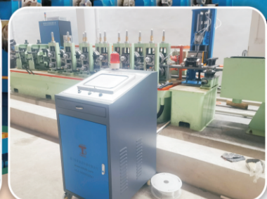
圆管焊缝探伤
