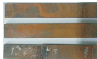
(b) 母材加载率 72\% \sigma_s
