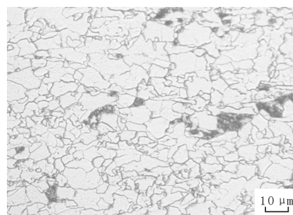
图 1 X70MS 耐酸钢板金相组织 500×
