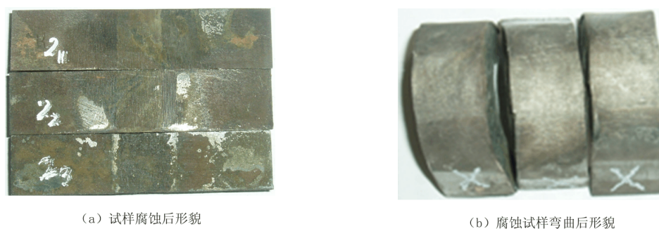
图 4 焊缝腐蚀试样及弯曲后的宏观形貌
