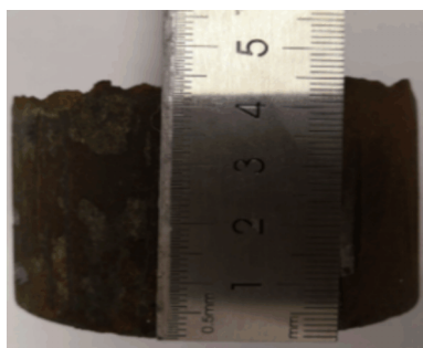
(a) 外壁断裂位置
