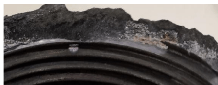
图13 圆螺纹缝隙腐蚀示意图
