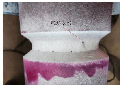
图 2 焊接练习管的缺陷示例
