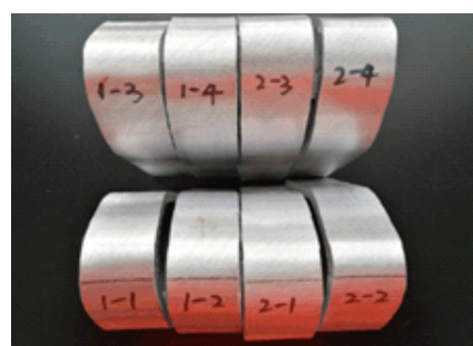
图 3 不同焊丝焊接接头弯曲试样
