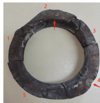
图 5 失效钻杆断口宏观形貌
