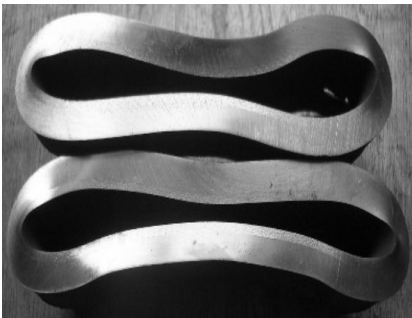
图 5 复合油管试样压扁试验后宏观形貌
