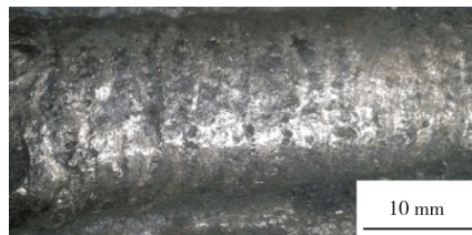
图 1 \text{AlCoCrCuFeNiMn}(\text{NbC})_{0.1} 高熵合金熔覆层外观形貌
