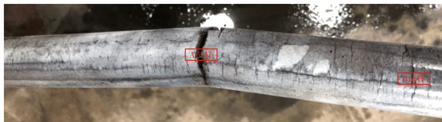
图 5 金相试样取样位置示意图
