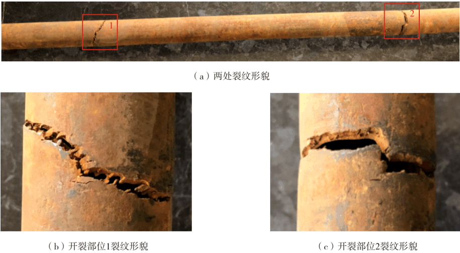
图 1 失效连续油管宏观形貌
