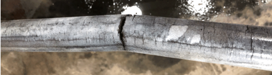
图 2 送检失效连续油管磁粉检测裂纹形貌
