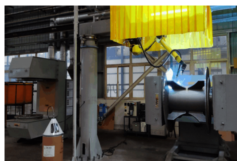
图 10 激振室焊接打压工作站应用实景图
