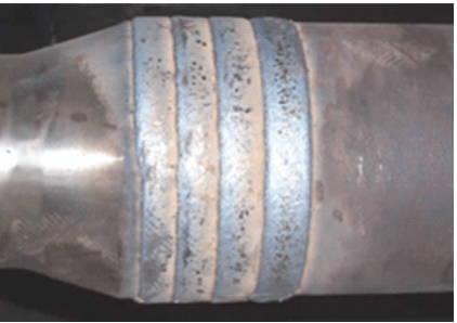
图 2 钻具接头上的耐磨带实物
