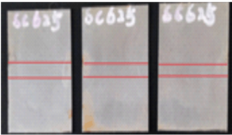
图 9 盐雾腐蚀试验结果
