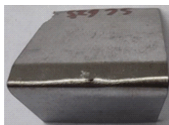
(c) 带错边烧穿补焊晶间腐蚀
