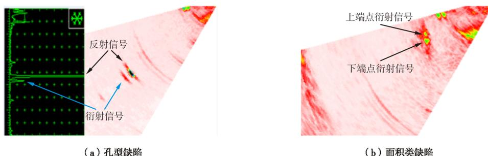
图 3 孔型缺陷和面积类缺陷分辨力示意图
