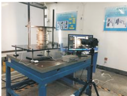
图12 压缩检测实验现场图
