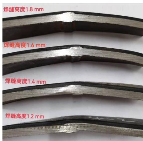
图1 不同焊缝高度涂层截面形貌
