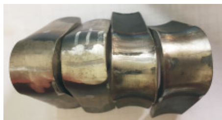
图2 焊接接头弯曲试样
