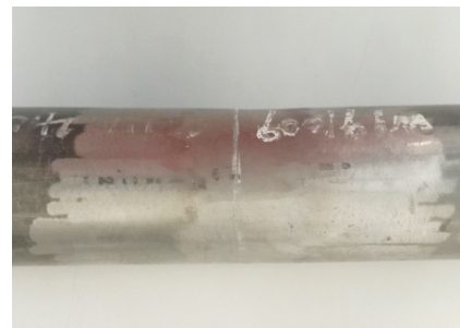
(b) 试验后焊接接头
