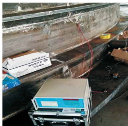
图5 盲孔法测量残余应力试验现场
