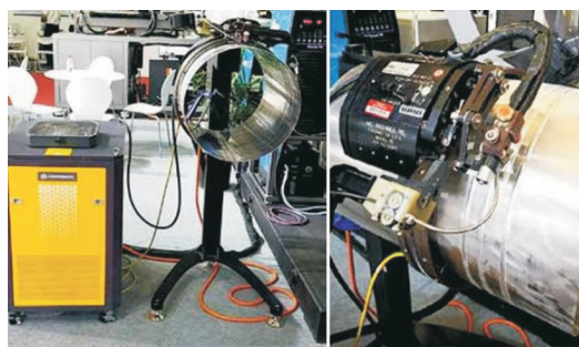
图3 DT数字化控制系统的管道全位置焊接系统
