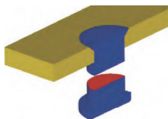
图7 紧固件失效示意图
