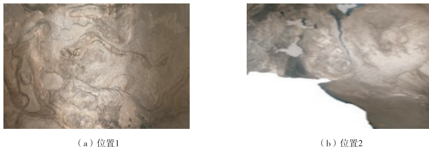
图2 管道内壁腐蚀形貌
