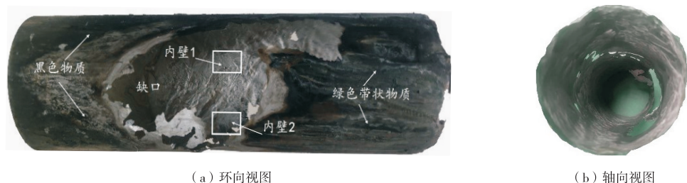
图1 失效管段宏观形貌
