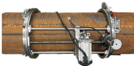
图11 氧化皮去除装置实物图
