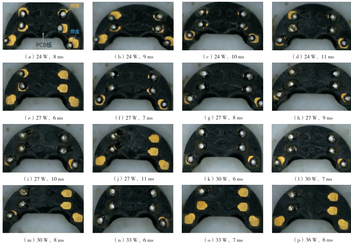
图2 不同参数下微焊点的宏观形貌
